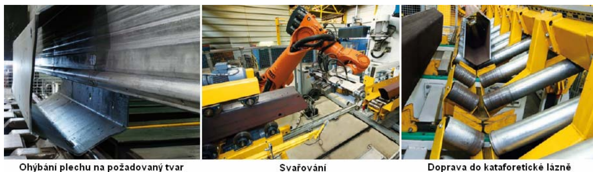
Obr.4. Automatizovaná výroba šestibokého profilu [5]
