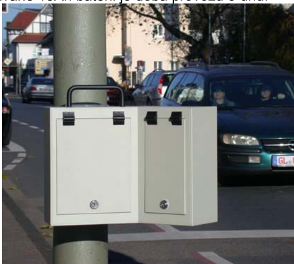
Obr.3. Měřicí zařízení VIACOUNT při měření
