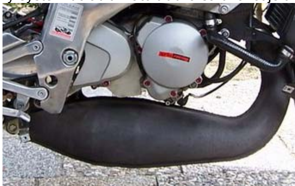
Obr.2. Dvojtaktný spaľovací motor s rezonančným výfukovým systémom
