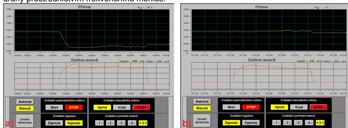
Obr.7. Měřící program určený ke snímání hodnot proudů elektromotorů a přičení jeřábu na jeřábových kolejnicích, a) stav bez regulace b) stav s regulací
