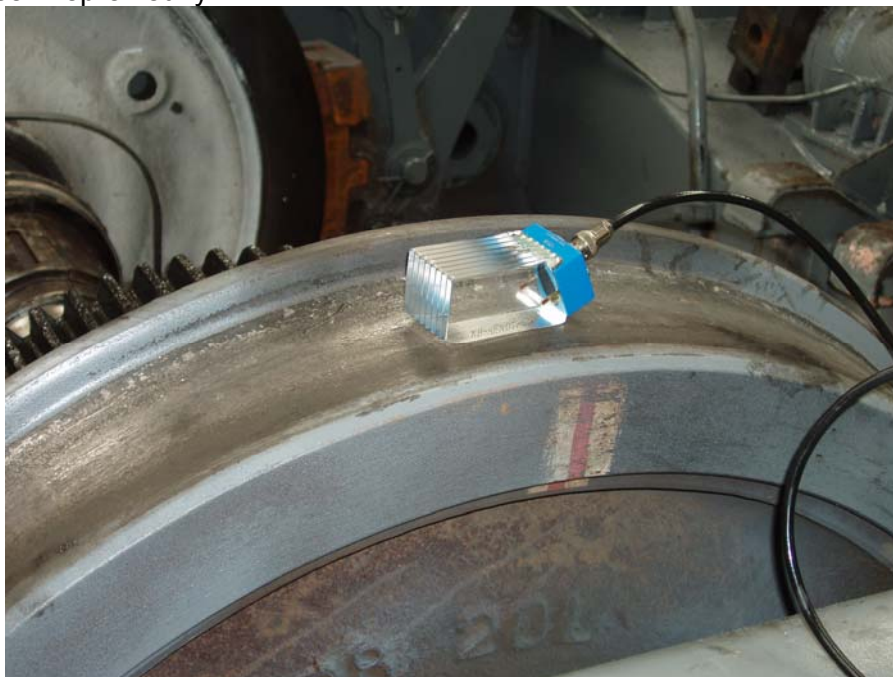
Obr.2. Přiložení sondy na zkoušený povrch
