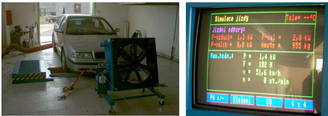
Obr. č. 2 Fotografie z měření emisí N_2O na standu Maha LPS 2000
