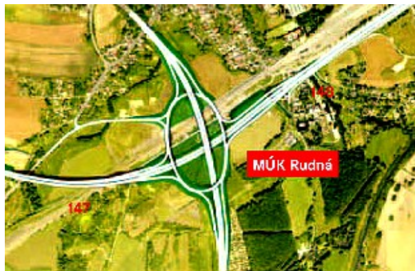
Obr. 4. Mimoúrovňová okružní křižovatka dálnice D47 – Rudná v Ostravě (schéma)
