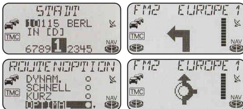
Obr. 4. Ukázky povelových signálů pro panelový navigační systém.
