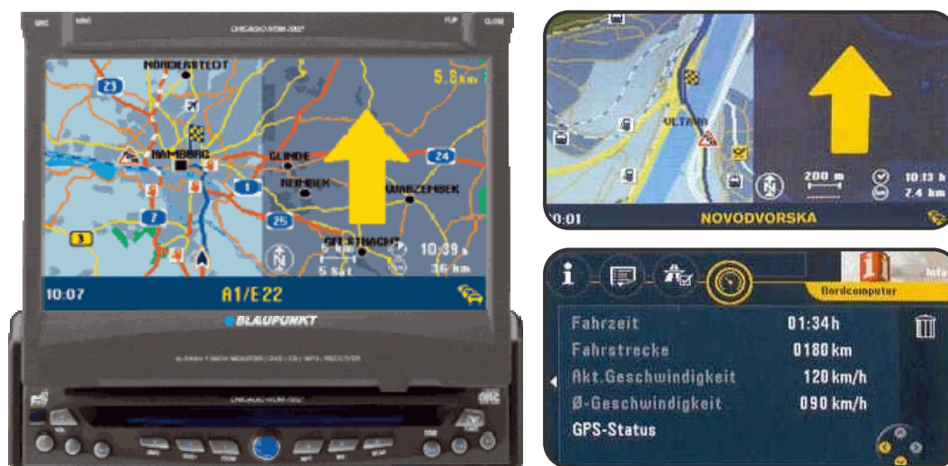
Obr. 5. Grafický navigační systém, smíšený režim zobrazení a provozní informace o jízdě.
