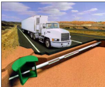
Obr.2: Instalace magnetické mikrosmyčky pod vozovku
