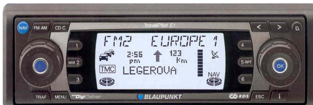
Obr. 3. Povelový princip navigace v autorádiu s podporou RDS – TMC.
