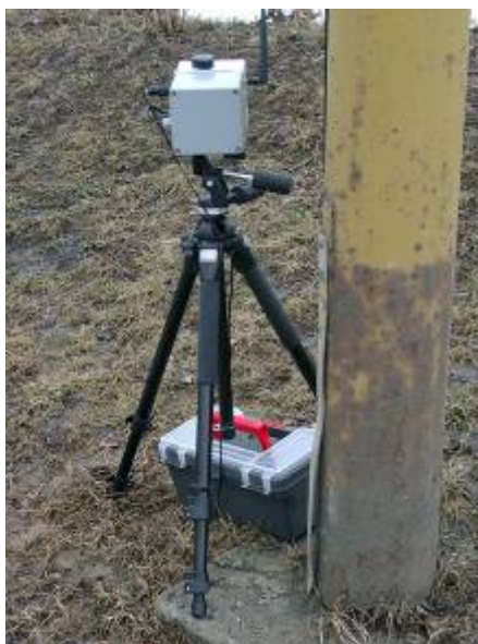
Obr.6. Falcon Plus II (pro snížení nežádoucího ovlivnění měření skrytý za VO)
