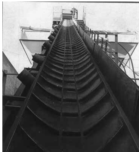
Obr. č. 9.5: Použití dopravního pásu se zešíkmenými příčnými žebry v strmé pásové dopravě
