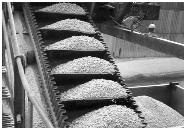
Obr. č. 9.6: Pás se příčkami a vlnitými bočními lemy pro strmou až svislou dopravu
